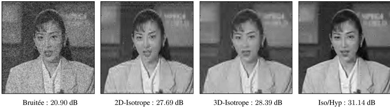
FIG. 2: Comparaison visuelle sur une frame de la séquence "Aniko". PSNR calculé sur toute la vidéo.
